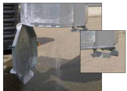
O esvaziamento dos contentores internos com válvula simples resume-se a elevar o sistema de argola simples com um gancho especial.
