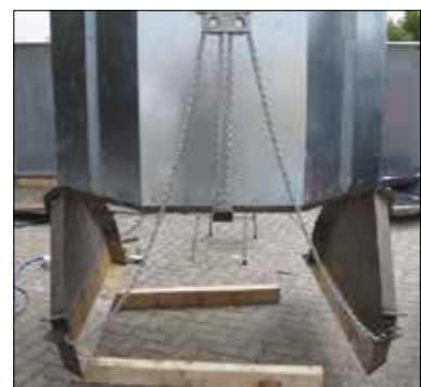
Dupla válvula de descarga, de abertura controlada. O interior do contentor equipado com dupla válvula não possui quaisquer partes móveis.
